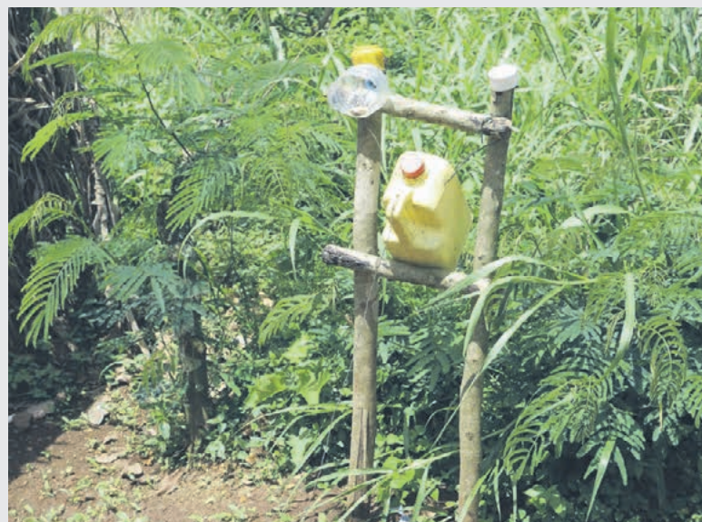
Berøringsfri håndvask med rennende vann utenfor en utedo i Hoima, Uganda. Trakk på jernstanga, så setter ståltråden plastkanna i bevegelse. Den har et hull nedenfor lokket og vannet strømmer ut. Såpe i den halve plastflaska opppe til venstre. Foto: Eva Bratholm
