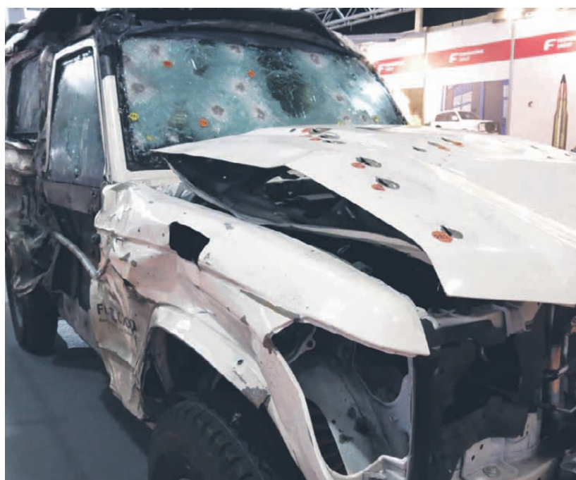
Pansringen av denne bilen er blitt testet av det tyske firmaet Farmingtons Automotive med nærmere fire hundre skudd fra en AK 47-gevær. En håndgranat ble også kastet mot bilen. FOTO: JAN SPEED
