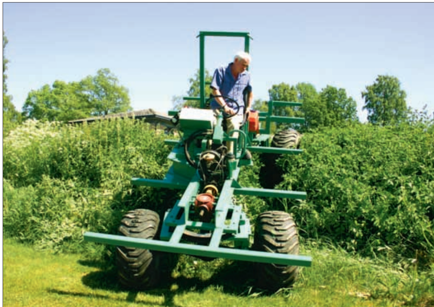
Mens vanlige landbrukstraktorer velter ved 32 grader, tåler «jungeltraktoren» 45 graders helling.
