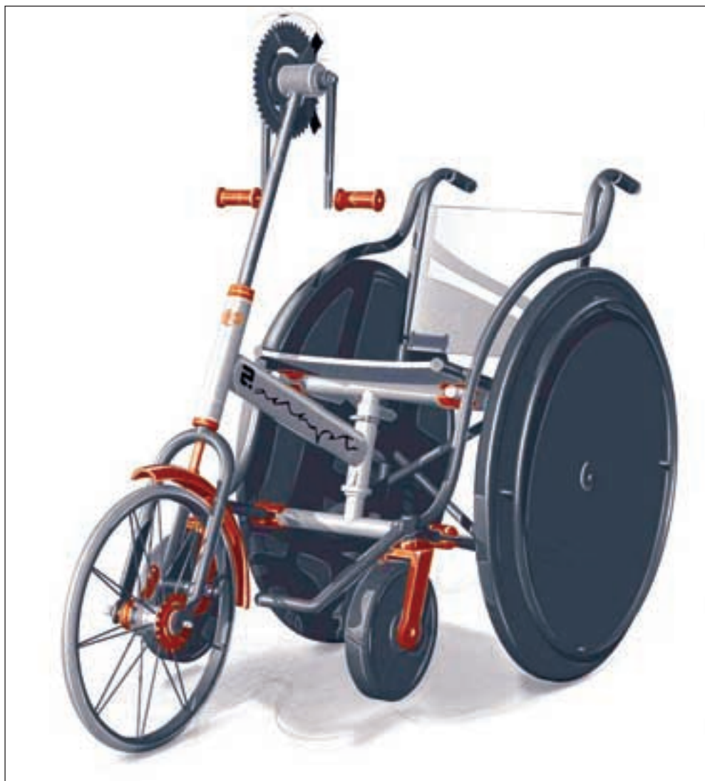
En såkalt trisykkel-adapter kobles til rullestolen. Designen er utviklet med tanke på bruk i utviklingsland. ILLUSTRASJON: NORSK FORM
