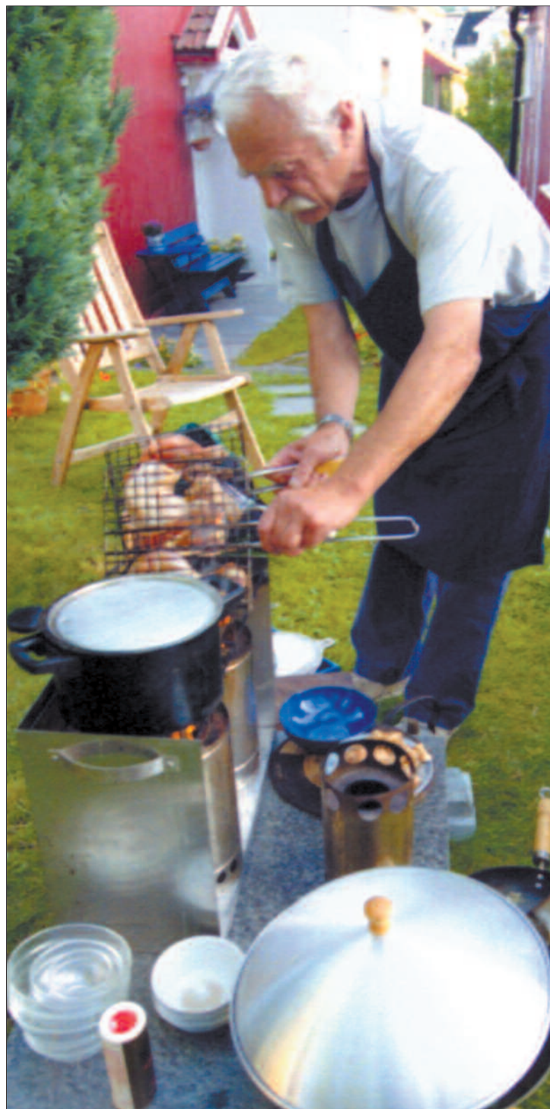
Peko Pe er to blikksylindere utenpå hverandre, som ved hjelp av et luftesystem kan brenne alt fra papiravfall til bananskall. Paal Wendelbo har stadig utviklet og forbedret ovnen.
